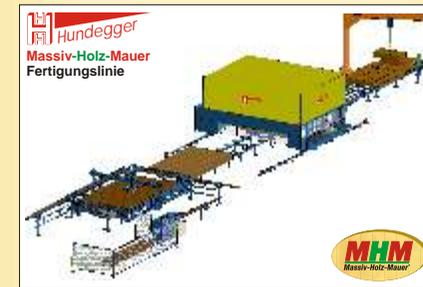
À partir de planches profilées, une machine de type « Wandmaster » produit des éléments bruts de murs dans des tailles de 2 m x 2 m jusqu'à 3,25 m x 6 m dans des épaisseurs allant de 11,5 cm à 34,0 cm dans lesquels les planches sont comprimées de manière croisée (en long et en travers) et clouées avec des clous striés en aluminium, couche après couche. Chaque assem-blage de planches croisées est pourvu de deux clous aux plus grandes distances possibles, en diagonal.
